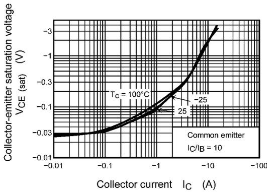
**Fig. 8.3  $V_{CE(sat)} - I_C$**
