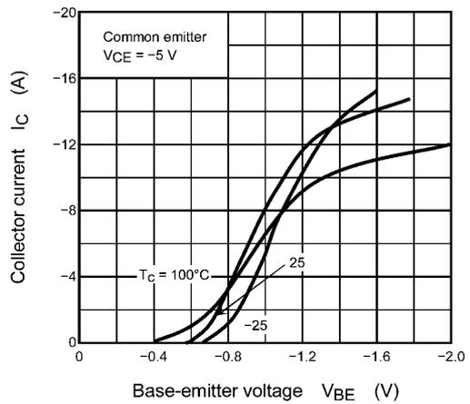
**Fig. 8.4  $I_C - V_{BE}$**
