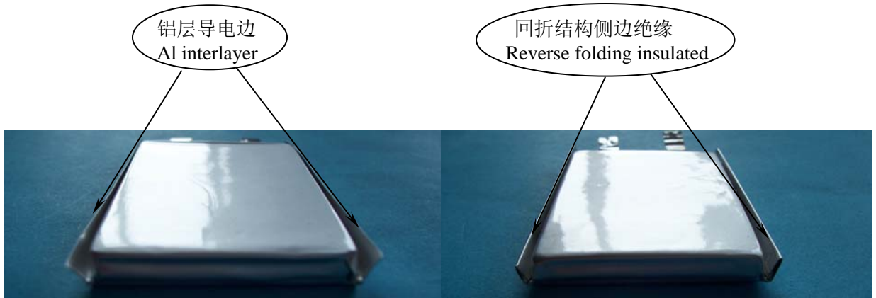
图 2: 锂聚合物电芯单层折边示意图 Single folding edge schematic of PL cells
