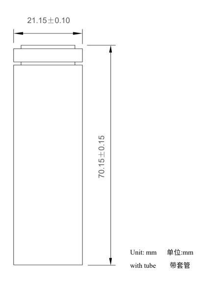
Fig. 1. Outline Dimensions of INR21700/50PL 图 1.INR21700/50PL 外形尺寸
