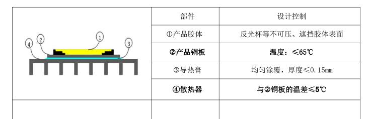
足瓦光源,请配足瓦厚料的外壳使用,每10W需要500g灯具,如果外壳轻了,LED就容易烧坏。散热一定要做好。请配套使用,安装要涂导热硅脂贴近散热片。
