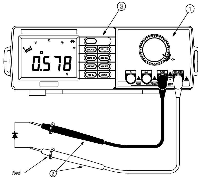
**Figure 2-7. Diode Tests**
