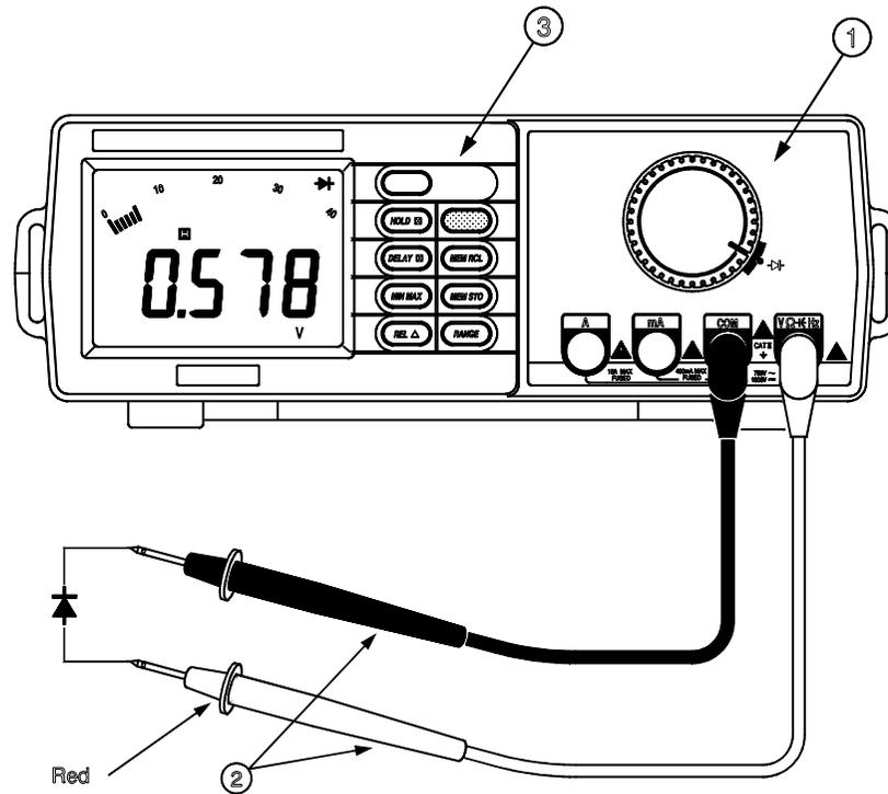
**Figure 2-7. Diode Tests**
